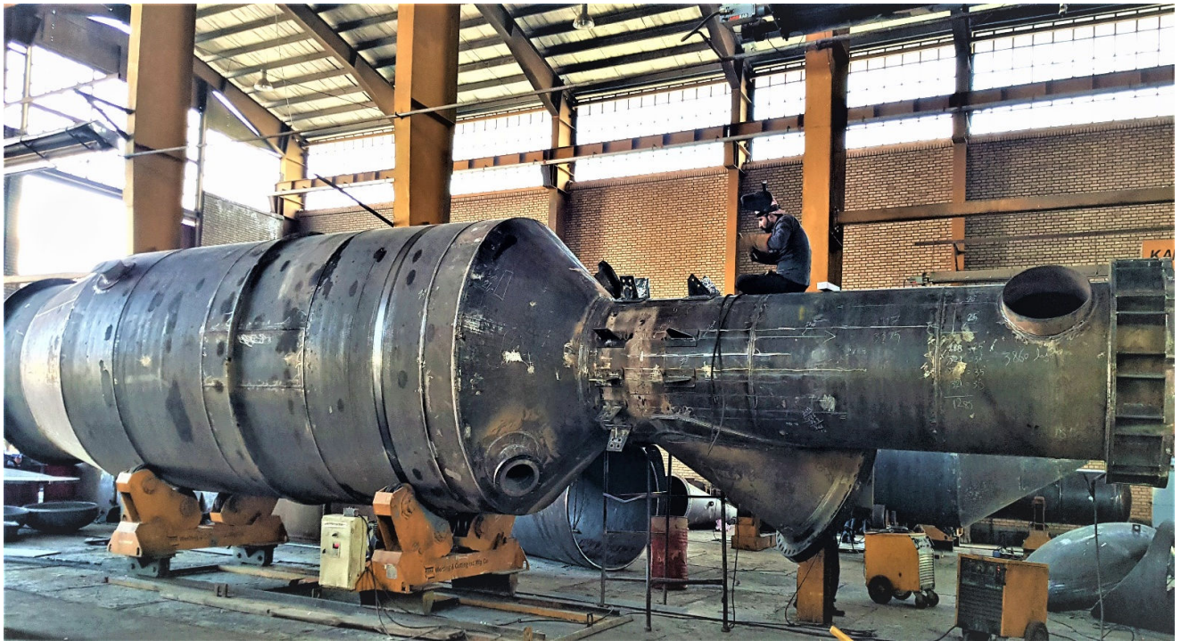
ونت استک طرح مولکولار سیل ایستگاه تقویت فشار گاز نورآباد (طراحی و ساخت برای اولین بار در ایران)
