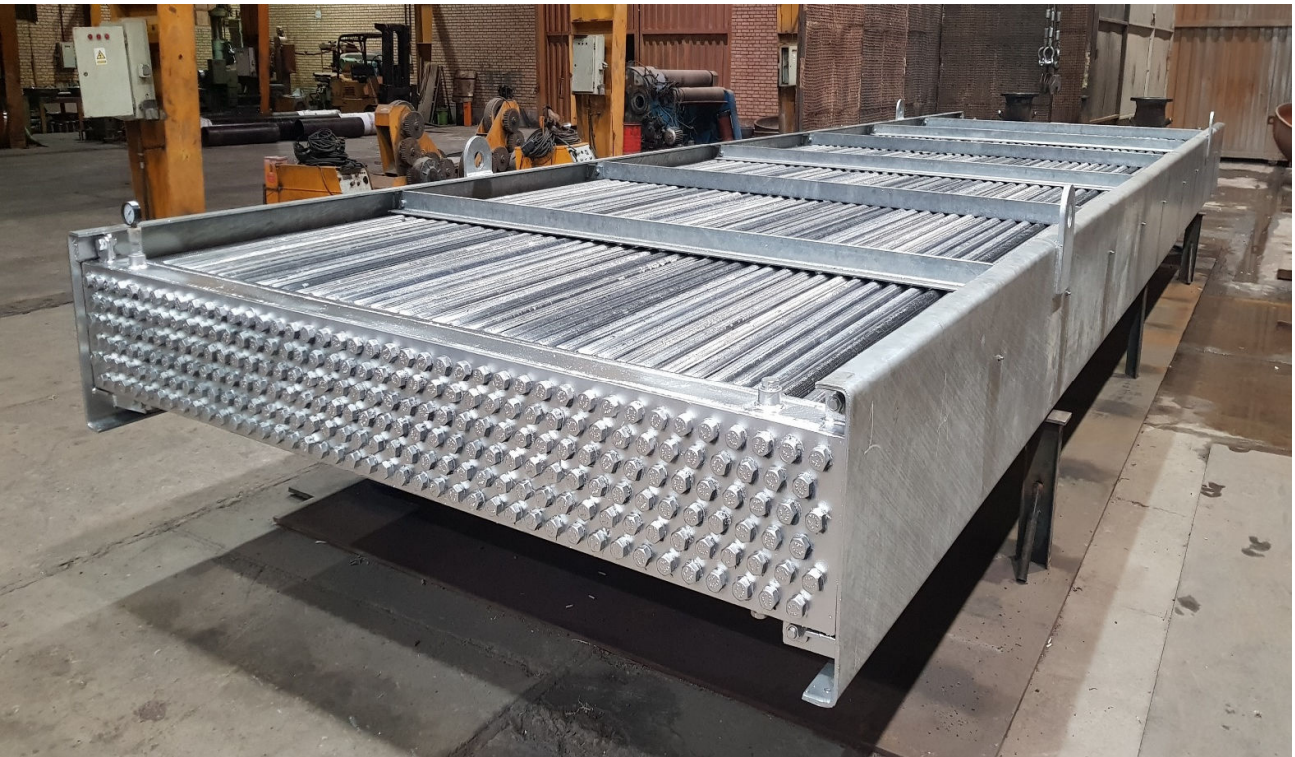
فین تیوب و باندل مربوط به ایرکولر پالایش نفت شیراز
