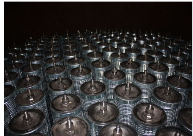
مجموعه فیلتر کوالسر جهت نصب در اسکراپ
