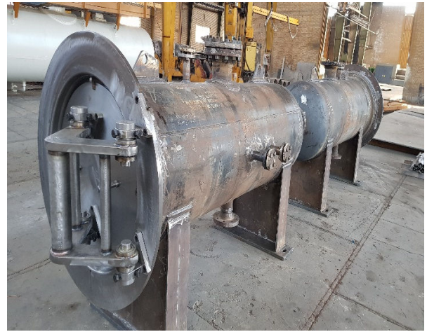
دریچه سریع باز شو با قطر 40 اینچ - فیلتر سپریتور مارون
