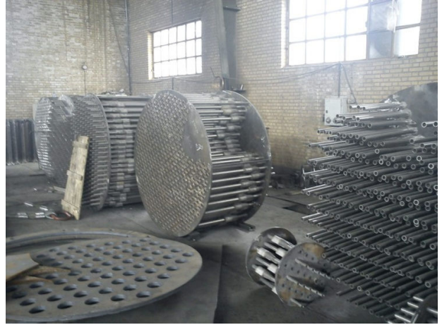
مجموعه سایکلونها جهت مونتاژ در اسکراپهای شرکت ملی گاز ایران
