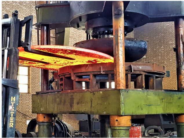
تولید و تامین کپ های الیپتیکال تا قطر ۲۰۰۰ میلیمتر و ضخامت ۱۰۰ میلیمتر
