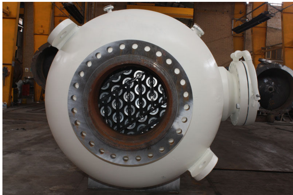
نازل خروج گاز از اسکراپ و نمای فیلترهای جاسازی شده در اسکراپ
