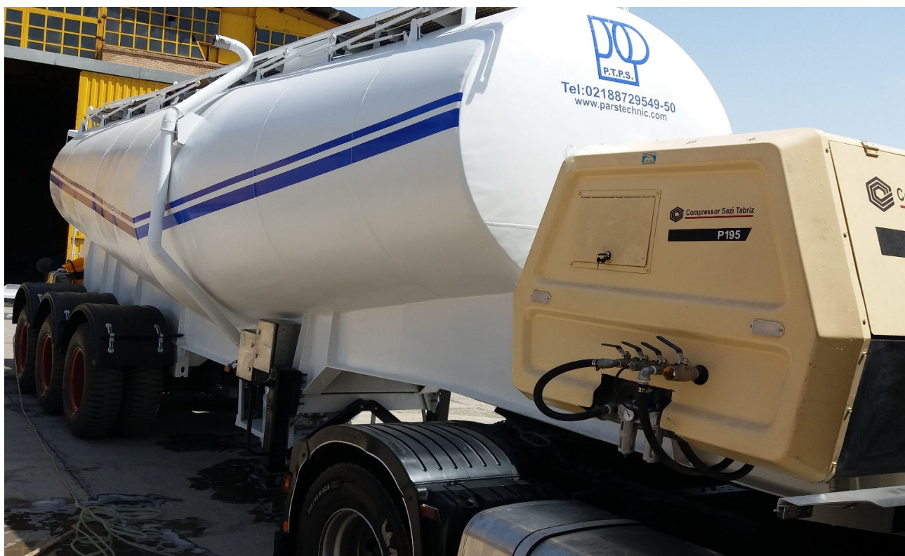
مخزن دو جداره استینلس استیل حمل ژل انفجاری معادن چادرمو
