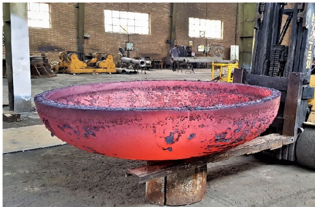
تولید و تامین کپ های الیپتیکال تا قطر ۲۰۰۰ میلیمتر و ضخامت ۱۰۰ میلیمتر
